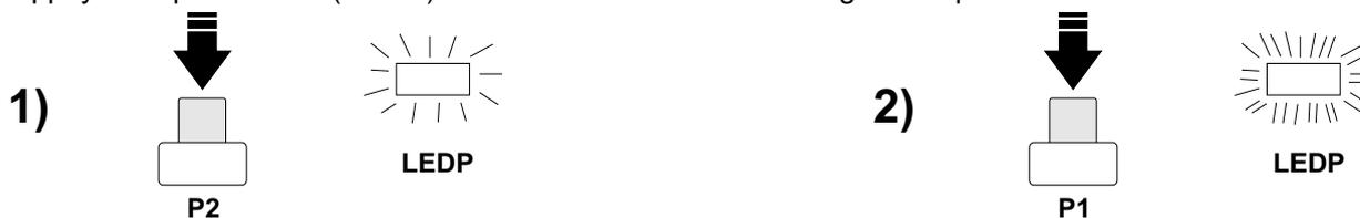
Envoyer une impulsion avec l' émetteur radio, utilisant le poussoir auquel on désire associer le commande de start piéton.
